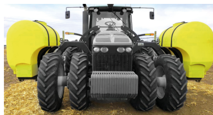
HI-VOLUME 500 GAL. PER SIDE TANKS
